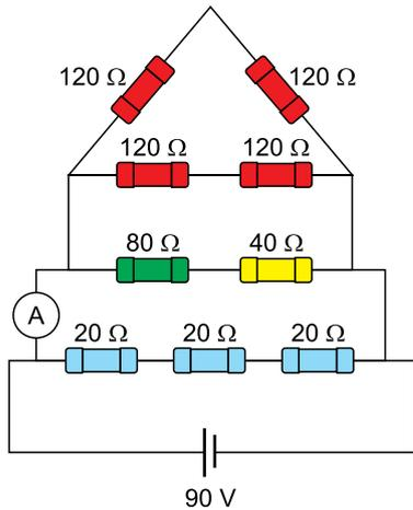
A intensidade da corrente elétrica medida pelo amperímetro é
